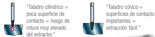
"Taladro cilíndrico = poca superficie de contacto = riesgo de rotura muy elevado del extractor."
