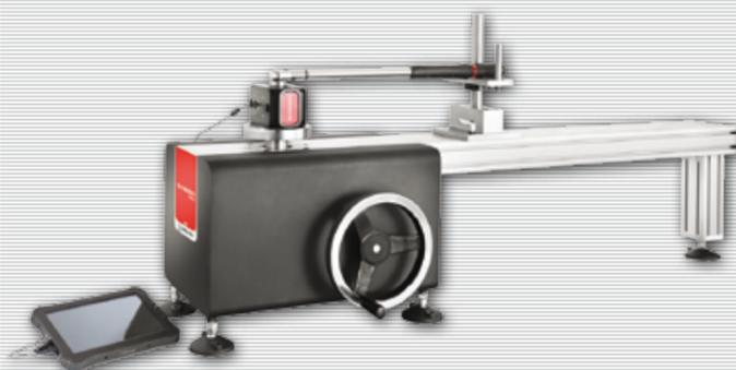
Cumpla las exigencias de la ISO y realice la medición con una llave totalmente horizontal (banco con barra de carga ajustable) y una relación de reducción de 1200:1, garantizando así un test exacto y repetible.
